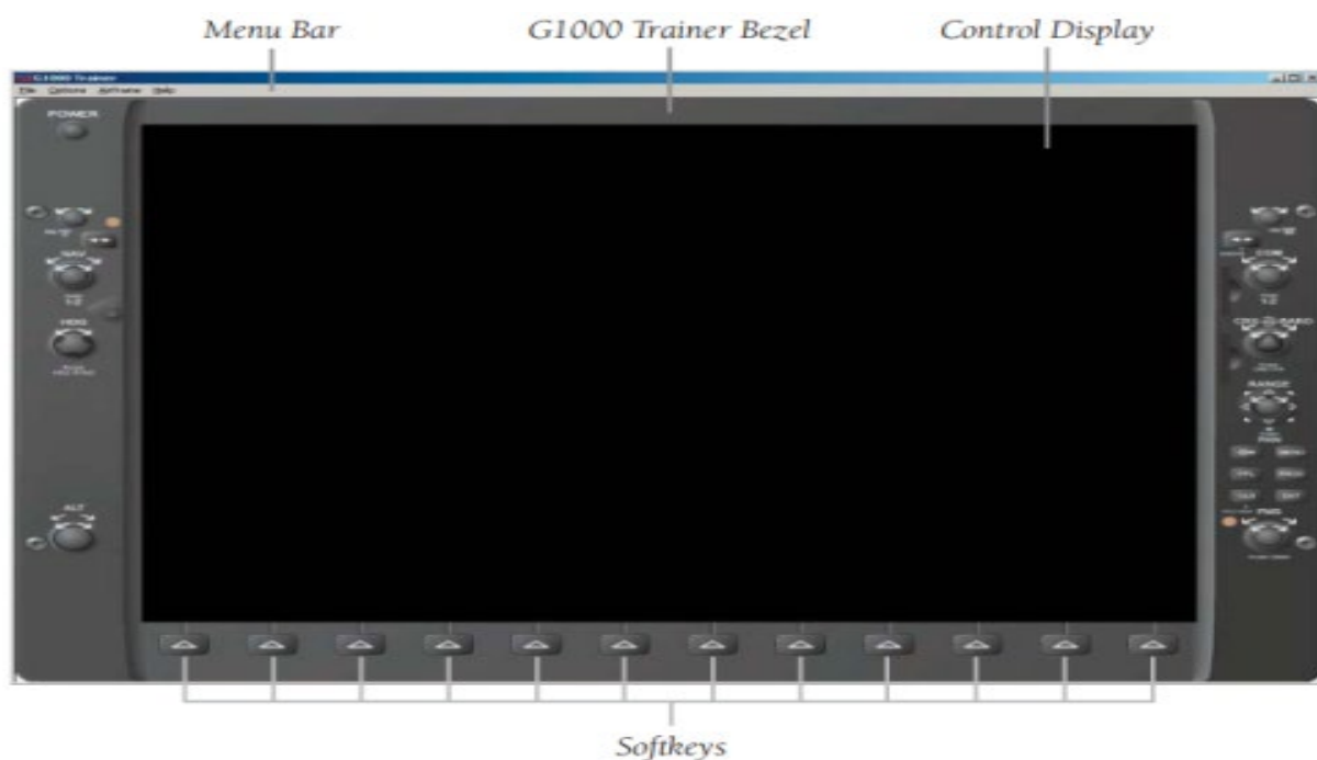
Рис. 15. – Тренажер отработки процедур управления радиотехническими средствами с Garmin G1000 [7]
