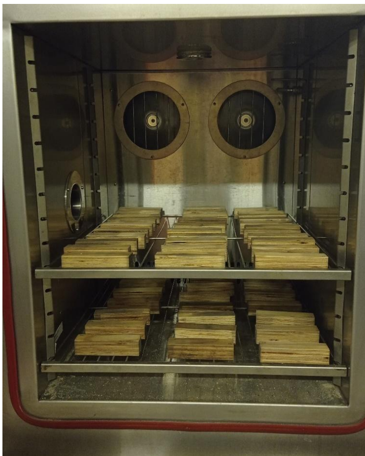
Рис. 3. Кондиционирование образцов в климатической камере
