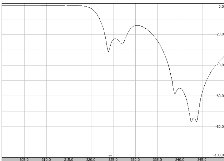
Рис. 6. – АЧХ дуплексера, канал приёма
