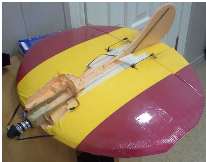
Рис.2 Следствием нескомпенсированного пикирующего момента на взлете является разрушающие нагрузки по центральной, передней части БПЛА
