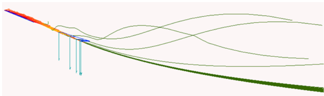
Рис. 7 Скос потока крыла при скорости в 4 м/с и угле в
