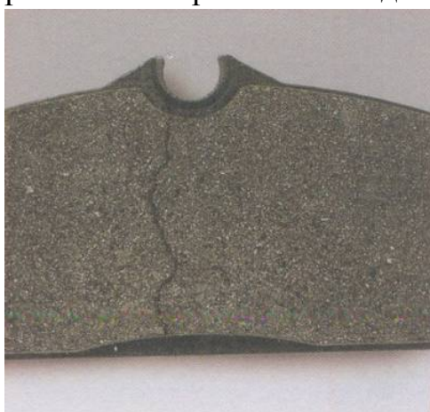
Рисунок 5 – Трещина рабочей поверхности колодки
