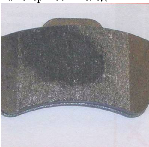
Рисунок 3 –Загрязнение рабочей поверхности колодки
