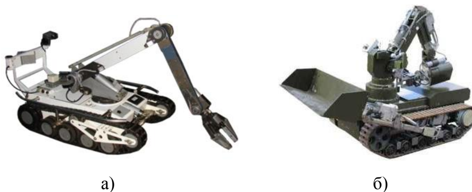
Рис. 1. Пожарные роботы среднего класса: а) МРК-27; б) МРК-46
