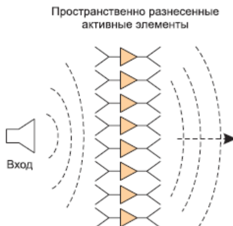
Рис. 2. Принцип пространственного суммирования мощности
