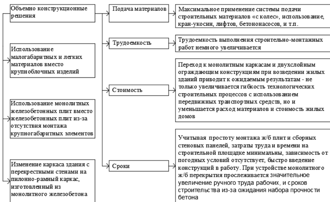
Рисунок 1. Схема изменения конструктивных характеристик жилых зданий
