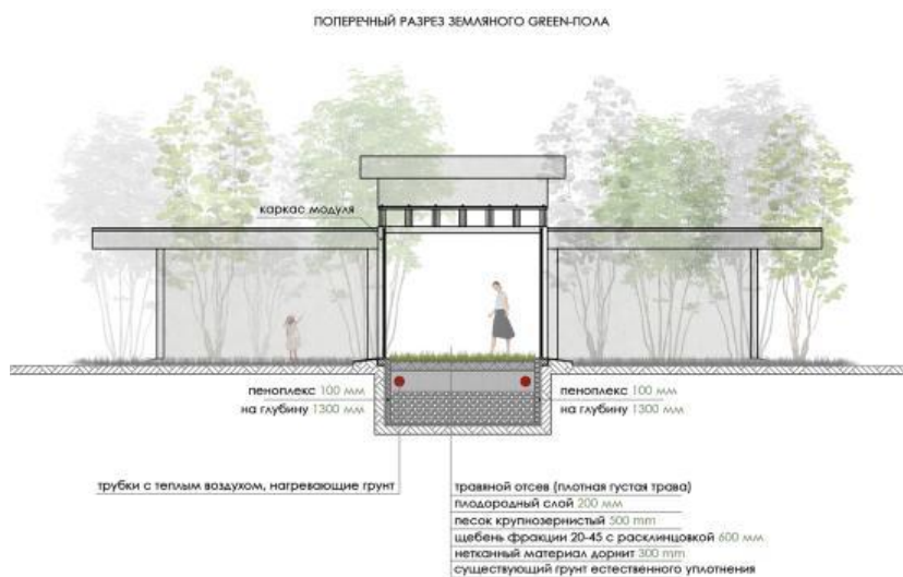
Рис. 2. – Устройство зеленого экологичного земляного green-пола
