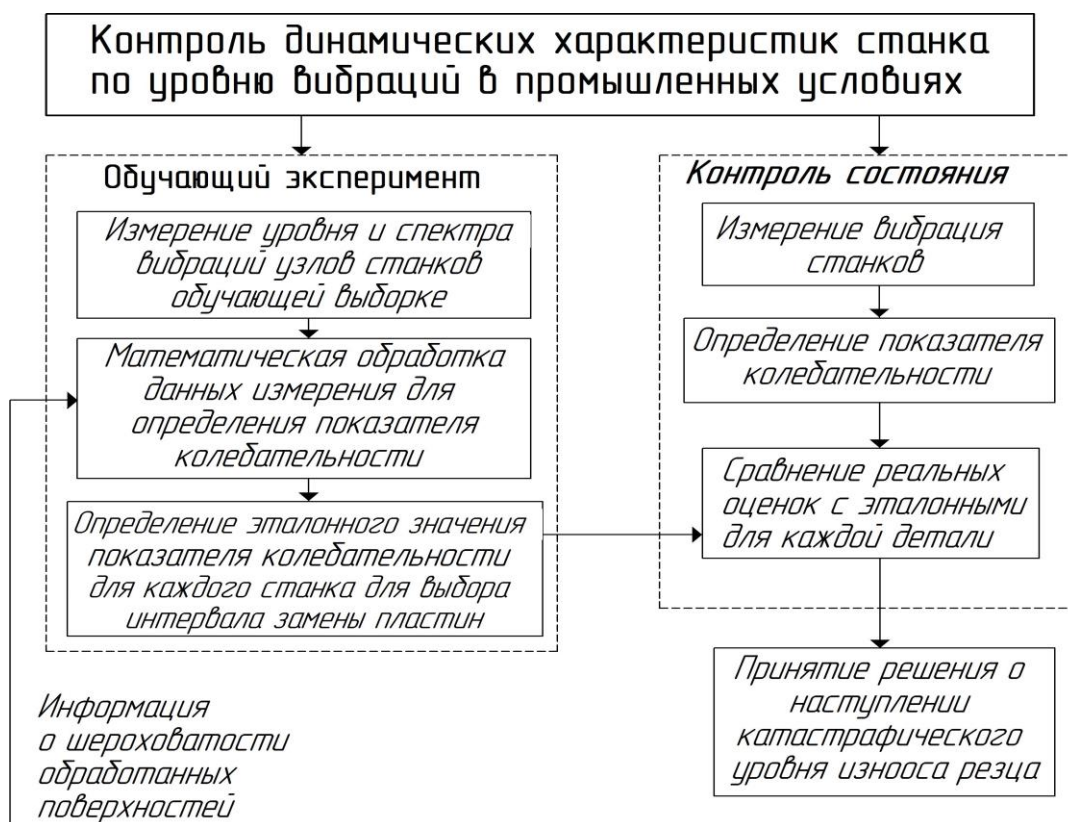
Рис. 2. – Алгоритм использования метода с применением показателя колебательности динамической системы на производстве.
