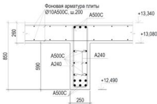
Рис. 2. – Армирование балки и плиты перекрытия
