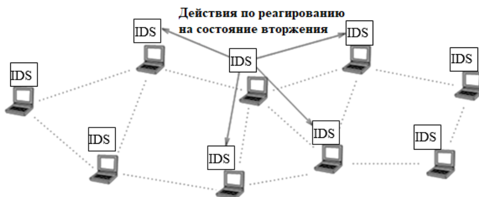
Рис. 1 – Архитектура IDS для одноранговых беспроводных сетей Можно выделить следующие виды обнаружений:
