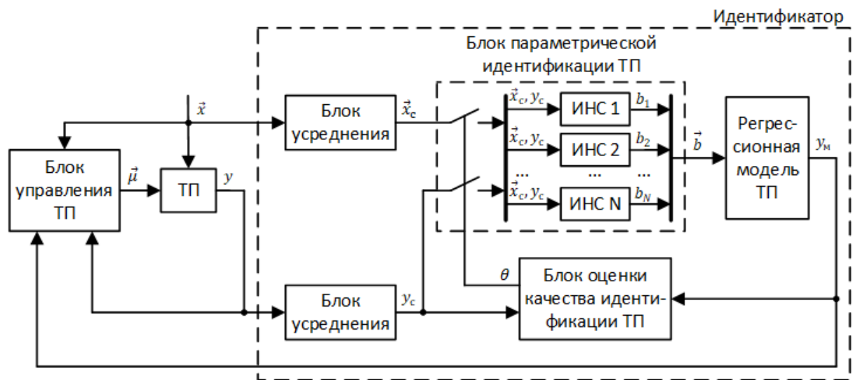
Рис. 1 - Структура системы идентификации: \vec{x} и y - входные и выходная технологические переменные; \vec{x}_c и y_c - усредненные переменные \vec{x} и y ; \vec{\mu} - управляющие воздействия; \vec{b} - параметры модели технологического процесса (ТП); y_m - переменная y , вычисленная по модели ТП; \theta - критерий качества параметрической идентификации; ИНС - искусственная нейронная сеть.
