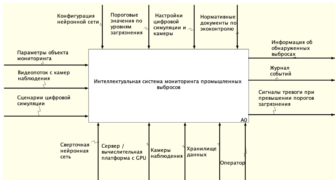
Рис. 1. — Контекстная модель интеллектуальной системы мониторинга промышленных выбросов в нотации IDEF0
