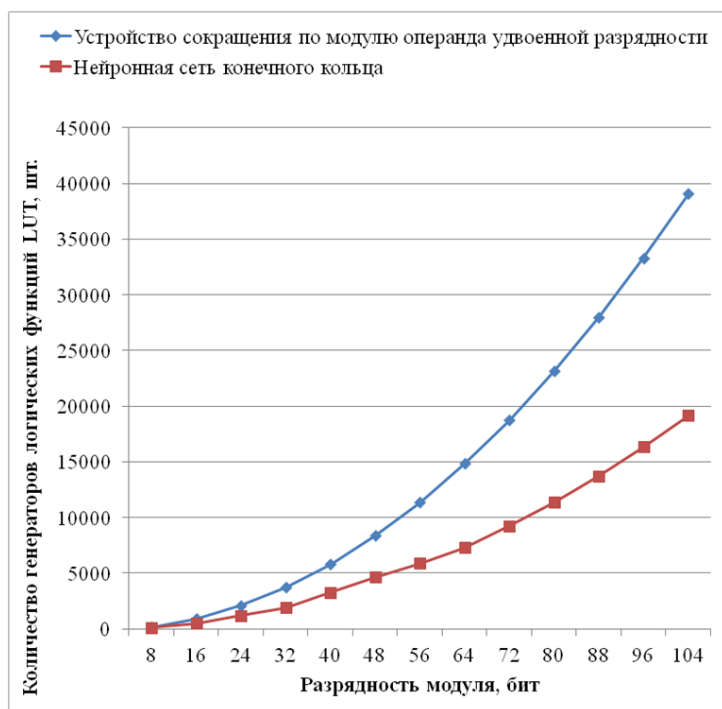
Рис. 14. – Сравнение аппаратных затрат на реализацию нерекурсивного устройства сокращения по модулю и нейронной сети конечного кольца
