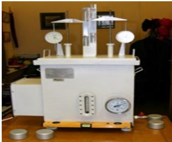
Рис. 2. Камера для проведения экспресс-испытаний: мягких и полужестких плит
