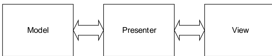
Рис. 3. – Схема шаблона проектирования « Model View Presenter »
