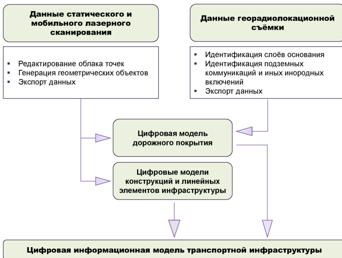
Рис. 4. – Схема формирования цифровой модели транспортной инфраструктуры по результатам изысканий
