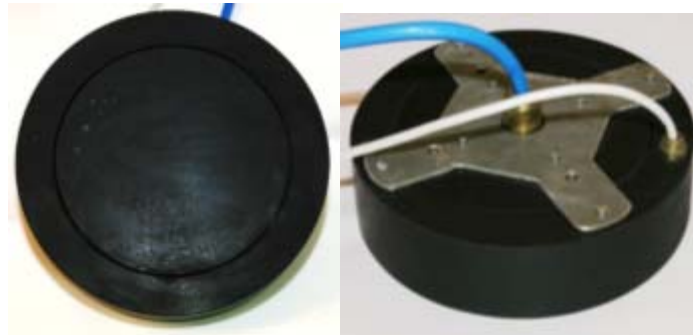
Рисунок 3 – Антенна накачки и приемная антенна широкополосного параметрического профилографа
