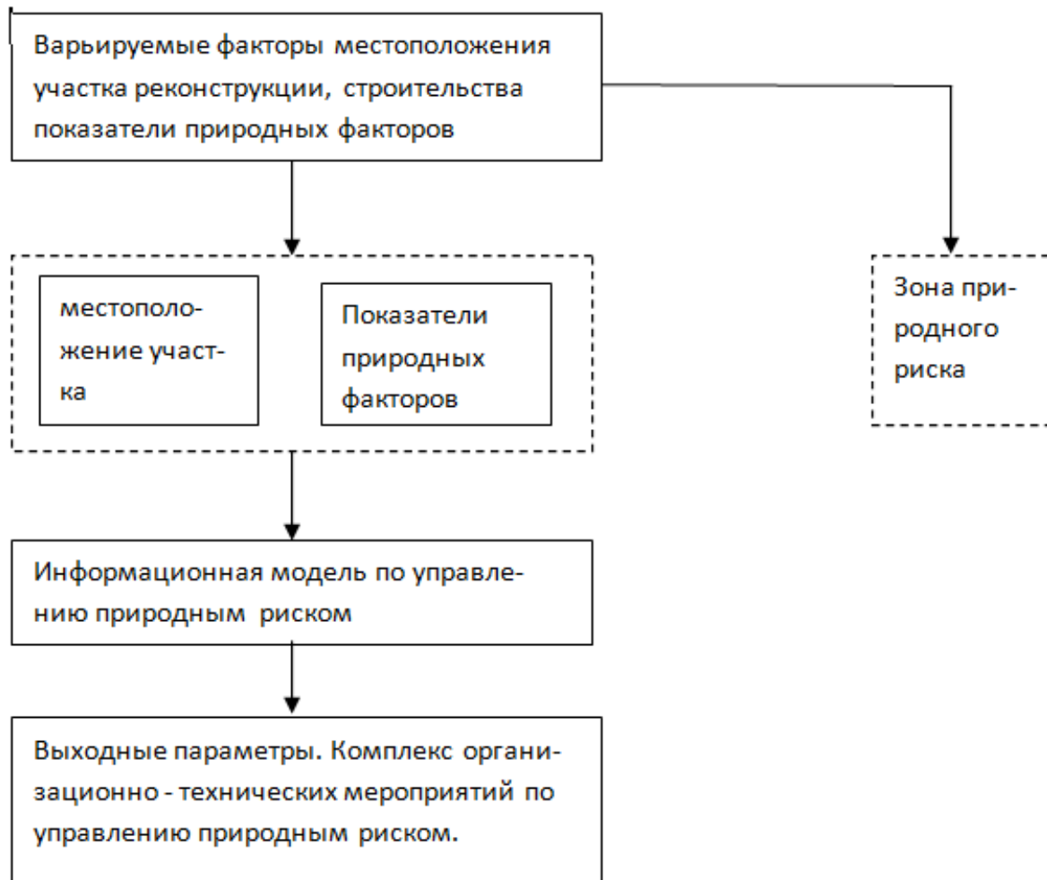
Рис. 2 Информационная модель обеспечения строительства и реконструкции (программный модуль)
