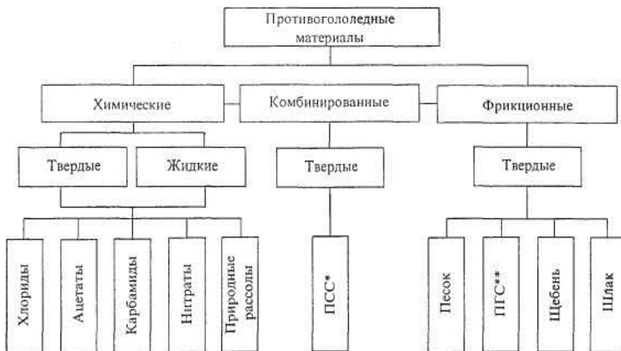
Рис. 1. - Классификация противогололедных материалов [1]
