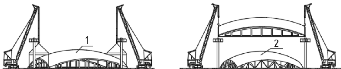
Рис. 5. Монтаж оболочки в целом виде методом вертикального подъёма: 1 – укрупнённая оболочка покрытия; 2 – кондуктор для укрупнительной сборки пологой оболочки
