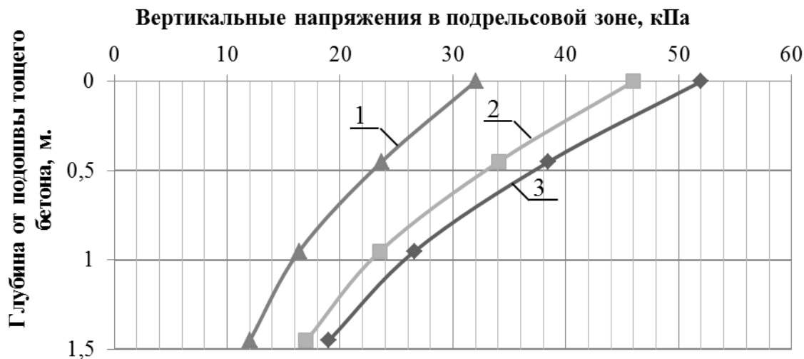
Рис.2 - Затухание вертикальных напряжений в подрельсовой зоне при различных типах подвижного состава: 1 - «Сапсан» ( V=70 км/ч); 2 - ЧС-2т ( V=70 км/ч); 3- ВЛ-10 ( V=70 км/ч).
