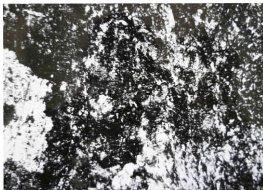
Рис. 2. Структура профрезерованного металла (×500)
