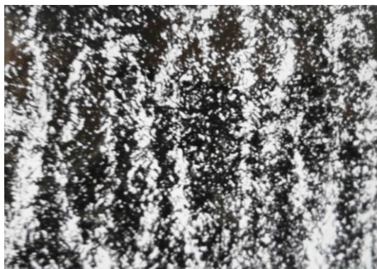
Рис. 4. Структура профрезерованного и прошлифованного новым кругом наплавленного металла ( \times 500 )
