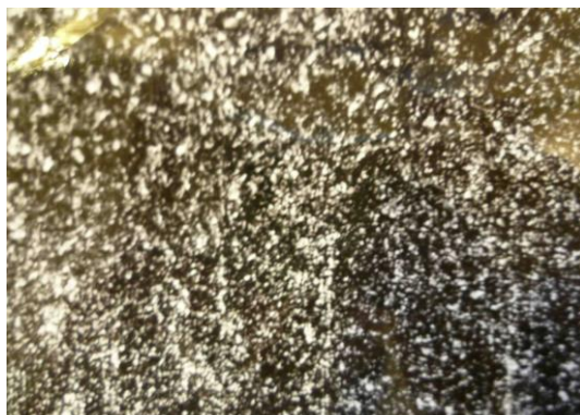
Рис. 5. Структура наплавленного металла, прошлифованного новым кругом в холодном состоянии детали ( \times 500 )
